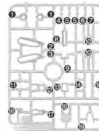
M1パーツ(ライトグレー) アンダーゲート有り (スチロール樹脂: PS)
