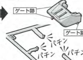
③ ニッパーの刃をパートに密着させてゲートを切り取れば、きれいに仕上がります。
