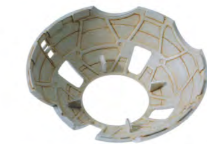
↑機体外装パーツの裏側。このモールドの形状はトラスフレームを意識したもので、すべての外装に施されている。
