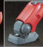
接地性を高める 踵の構造。
